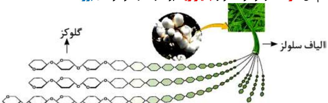
✓ در ساختار **سلولز**، بین دو حلقه یک اتم **O** قرار گرفته است و در داخل هر حلقه نیز یک اتم **O** وجود دارد.
