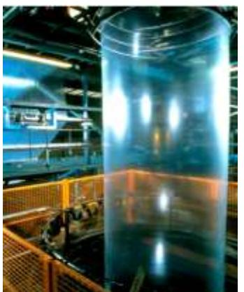
✓ در هنگام ساخت این وسایل دانه‌های **سفید** پلی اتن را **مذاب** کرده و در دستگاهی با **دمیدن هوا**، به ورقه **نازک** پلاستیکی تبدیل می‌کنند.
