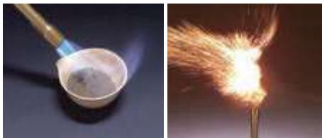
**مثال ۱:** شعله آتش، گرد آهن موجود در کپسول چینی را داغ و سرخ می کند؛ در حالی که پاشیدن و پخش کردن گرد آهن بر روی شعله، سبب سوختن آن می شود.
