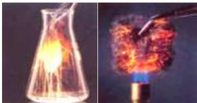
**مثال ۱:** الیاف آهن در مجاورت **هوا** (شامل ۱۲۱٪ اکسیژن) روی شعله، **داغ و سرخ** شده اما **نمی سوزد**.
